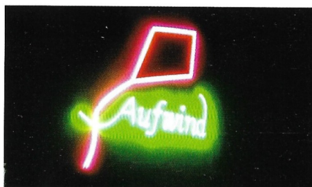
25.1 Neonröhren: Je nach Gasfüllung oder innerer Beschichtung wird eine bestimmte Lichtfarbe erzeugt (Fotografie).
