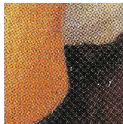
24.4 vierfarbiger Rasterdruck in vielfacher Vergrößerung (Detail aus Bild 35.1); subtraktive und optische Farbmischung
