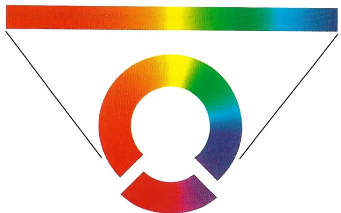
22.3 Das sichtbare Spektrum und seine Übertragung in ein Kreisschema („Newton'scher Kreisschluss“); dabei wird das im Lichtspektrum nicht enthaltene Purpur hinzugefügt.
